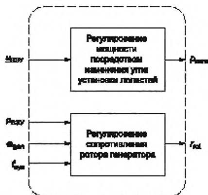
Рисунок 10 — Структурная схема модуля управления модели ВЭУ типа 2
