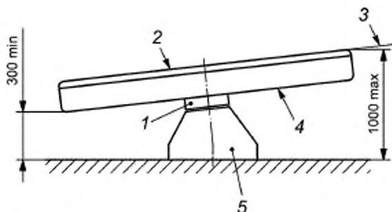
1 — подшипник; 2 — верхняя поверхность; 3 — наклон; 4 — нижняя поверхность;
