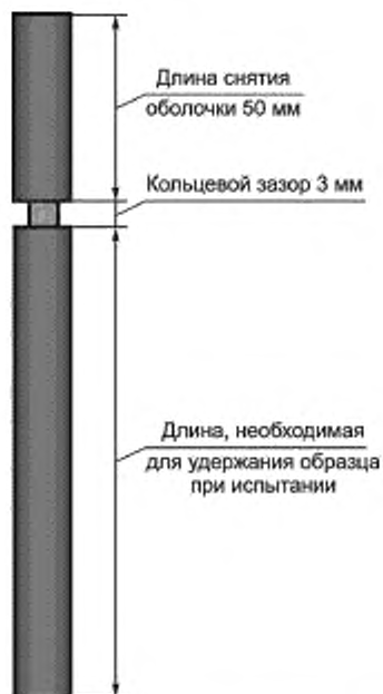
Рисунок 30 — Разделка испытуемого образца ОК
