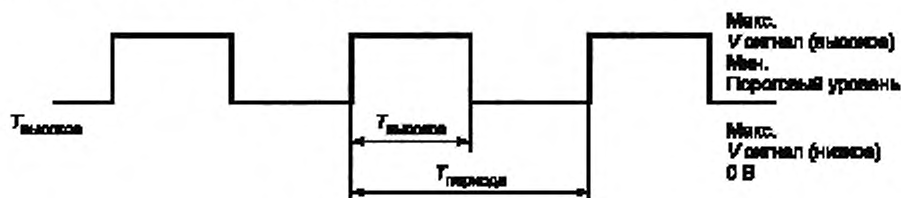
Рисунок E.5a — Типичный ШИМ-сигнал
