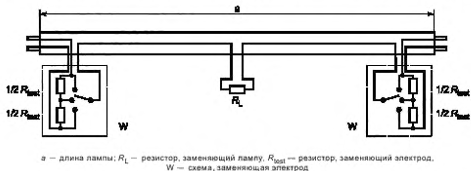
Рисунок F.1 — Макет лампы для замены двухцокольных люминесцентных ламп
