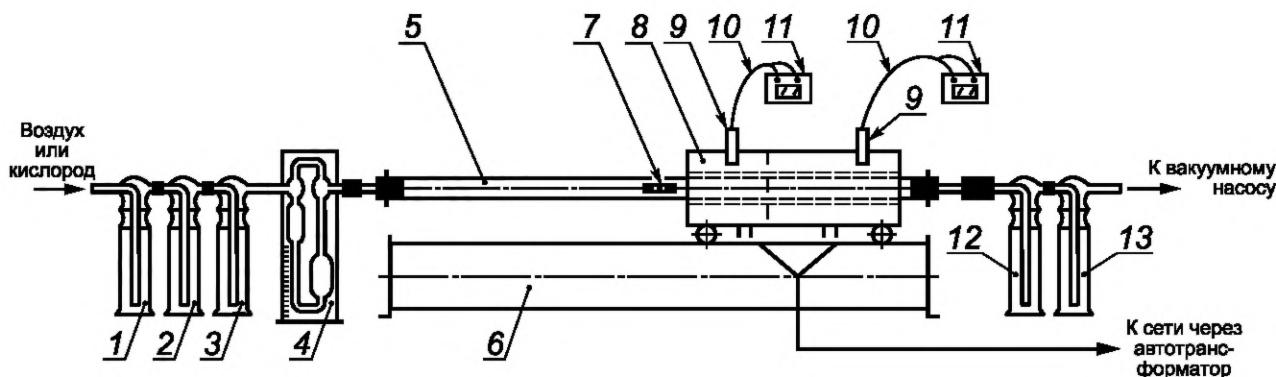
1, 2, 3 — склянки для очистки воздуха; 4 — реометр; 5 — кварцевая или фарфоровая труба; 6 — подставка для печи;
