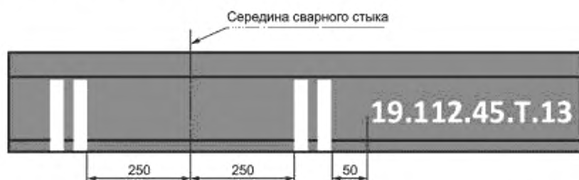
Рисунок 3 — Маркировка стыка РКС, сваренного в пути (размеры в миллиметрах)
