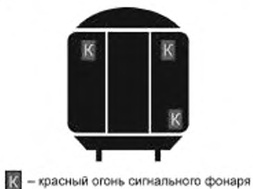
Рисунок 1 — Размещение сигнальных фонарей на торцевых стенах вагона
