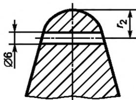
Для крюков с № 6 до № 250 в отверстие следует установить штифт из нержавеющей стали, не выступающий за пределы тела крюка
