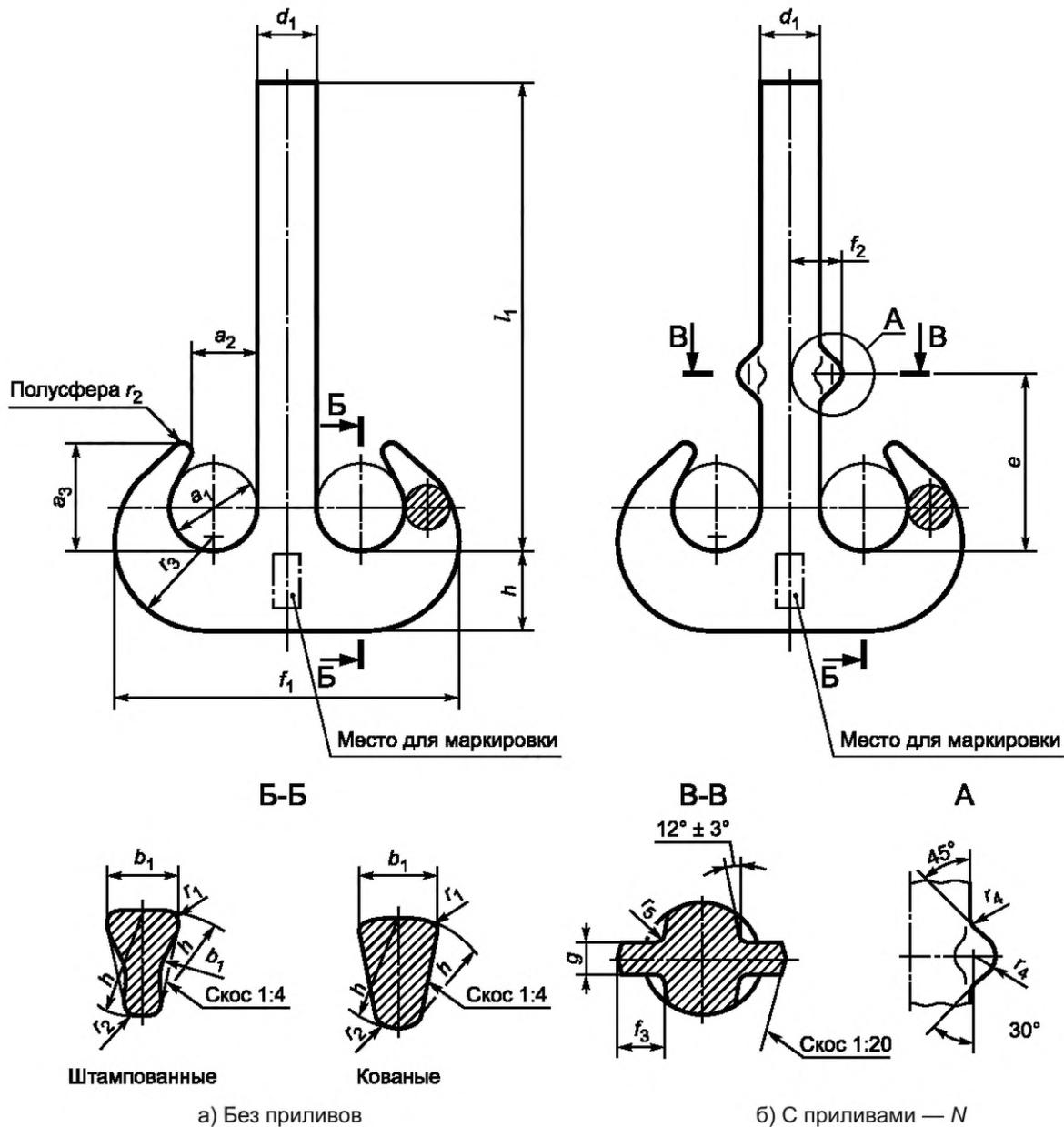
Рисунок 5 — Заготовки двурогих крюков категории IV
