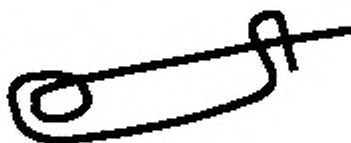
Рисунок 6 — Стальная булавка для запираания аварийного люка
