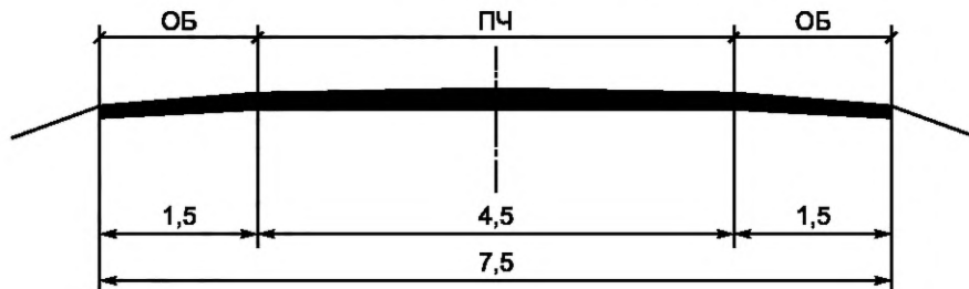
в) Типовой поперечный профиль автомобильных дорог категорий VA и VB (кроме подъездов к промышленным предприятиям и месторождениям полезных ископаемых)
