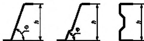
Рисунок 4 — Требования по соотношению высоты и толщины профиля
