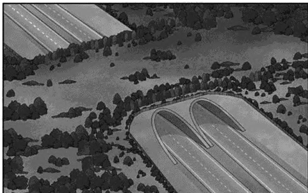
Рисунок Е.1 — Экодук мостового типа с пролетным строением из металлических гофрированных труб
