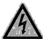
а) «Опасность поражения электрическим током» (ГОСТ 12 4 026—2015, таблица Ж.1, W08)
