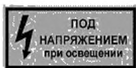
б) «Под напряжением при освещении»
