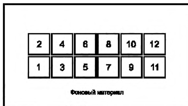
Рисунок А.5 — Пример тест-таблицы для испытания на передачу серой шкалы
