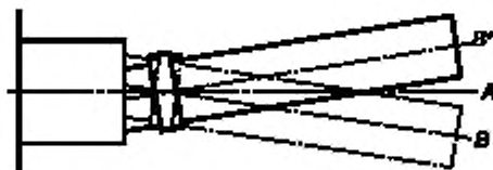
А — ось вращения; В — ось контрольной оправки в позиции 0°; В' — ось контрольной оправки в позиции 180°
