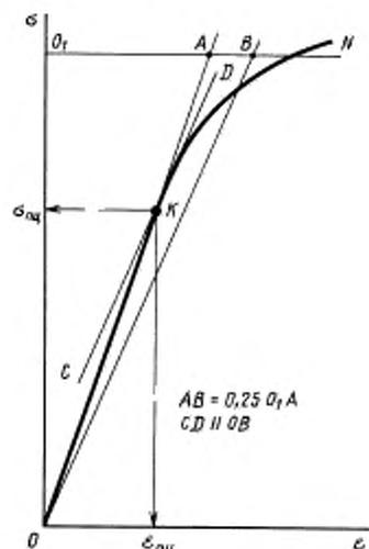
**2. ОПРЕДЕЛЕНИЕ ОТНОСИТЕЛЬНОГО УДЛИНЕНИЯ КЛЕЯ ПРИ УСЛОВНОМ ПРЕДЕЛЕ ПРОПОРЦИОНАЛЬНОСТИ**
