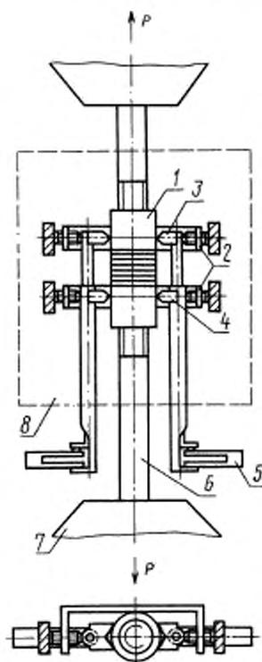
1 — образец; 2 — прижимная планка; 3 — внутренняя штанга с опорной призмой; 4 — внешняя штанга с опорной призмой;
