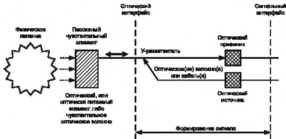
Рисунок А.3 — Конфигурация ВОД с пассивным чувствительным элементом и одним волоконным выводом для оптических входа и выхода
