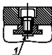
Рисунок D.6 — Правильное расположение гаек и болтов
