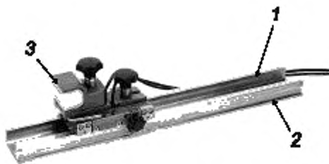
1 — цифровая линейная шкала, 2 — монтажное основание с направляющей; 3 — считывающая головка
