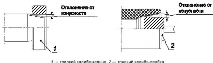
Рисунок 4 — Проверка конусности резьбы гладкими калибрами
