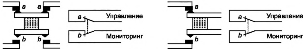
Рисунок А.1 — Контакты реле
