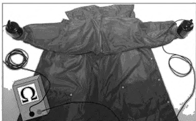
Рисунок 4 — Схема расположения оборудования для испытаний: сопротивление «от точки до точки» (метод «манжета—манжета» с использованием изолирующих вкладышей)
