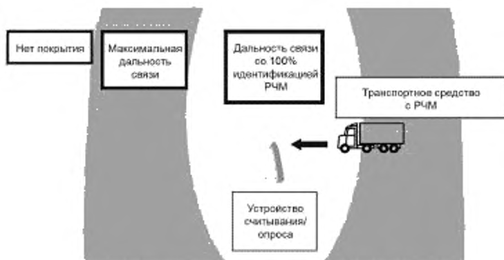
Рисунок 39 — Установка для испытаний по ГОСТ Р ИСО/МЭК 18000-7. Эффективность функционирования в движении
