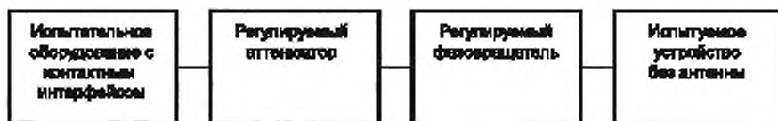
Рисунок 4 — Испытательная установка с контактным соединением
