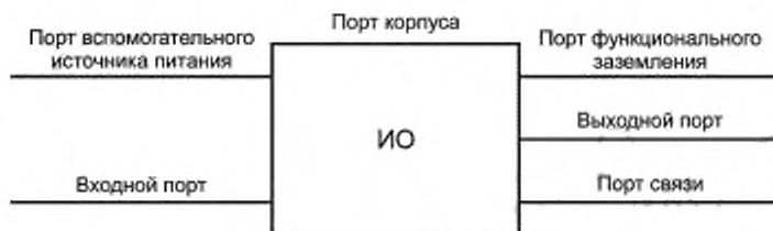
Рисунок 1 — Порты для измерительных реле и защитного оборудования
