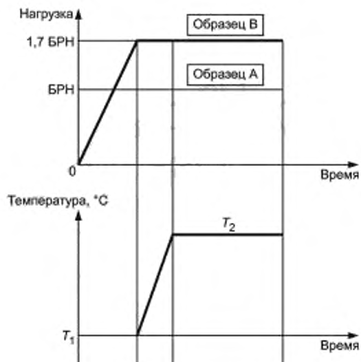
Рисунок 1 — Диаграммы приложения нагрузки и температуры при выдержке образца в течение времени по 10.2.1.3
