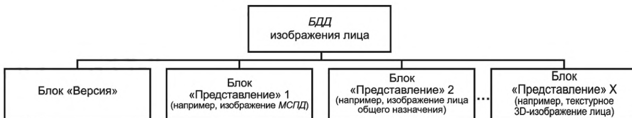
Рисунок 2 — Пример встраивания нескольких представлений в один блок «Данные изображения лица» (Face image data)
