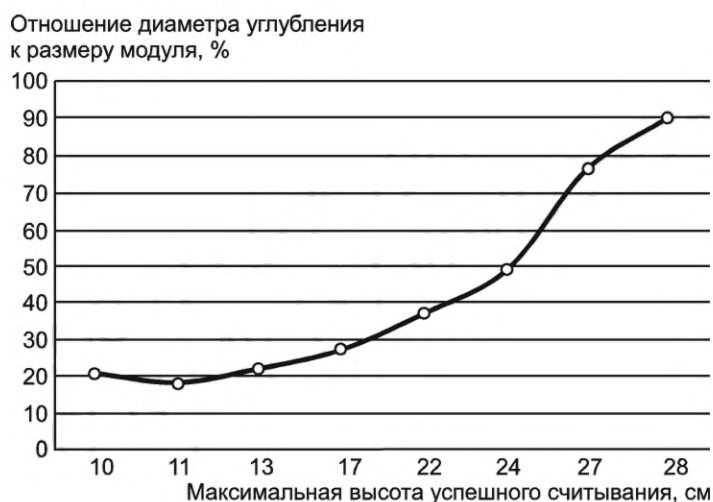
Рисунок А.2 — Зависимость максимальной высоты успешного считывания символа штрихового кода от отношения диаметра углубления с частицей флуоресцентной композиции к размеру модуля символа штрихового кода
