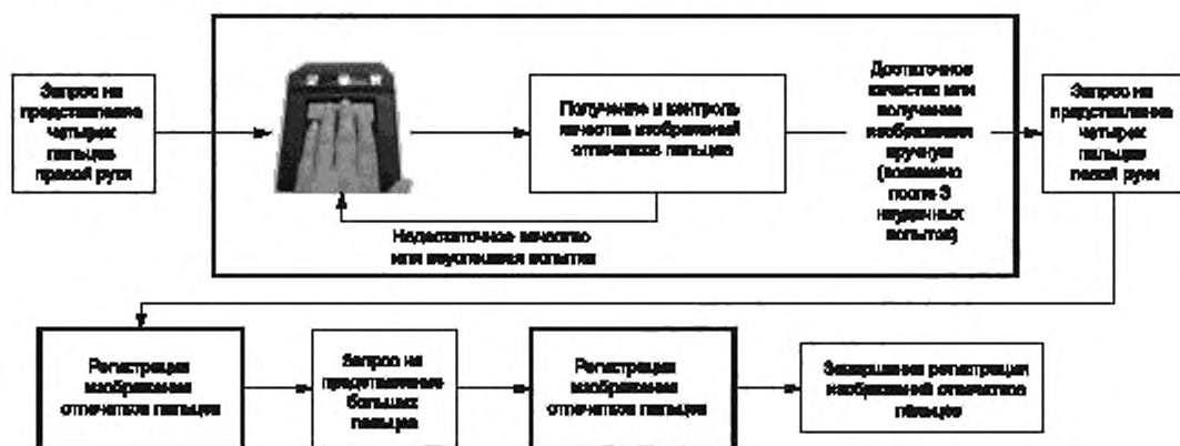
Рисунок А.1 — Обобщенная схема регистрации отпечатков десяти пальцев
