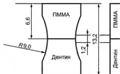
Рисунок А.4 — Размеры образца мини-версии Dumbbell [4]
