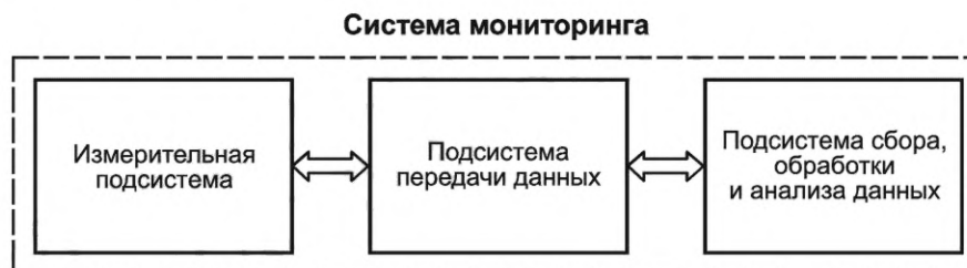
Рисунок 1 — Обобщенная структурная схема системы мониторинга
