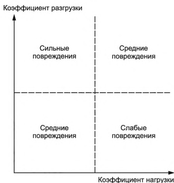
Рисунок 3 — Оценка степени повреждения железобетонных балок на основании коэффициентов нагрузки и коэффициента разгрузки
