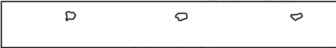
c — пример 3: три несовершенства размером 4,0 мм
