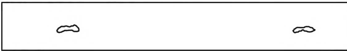
b — пример 2: два несовершенства размером 6,0 мм
