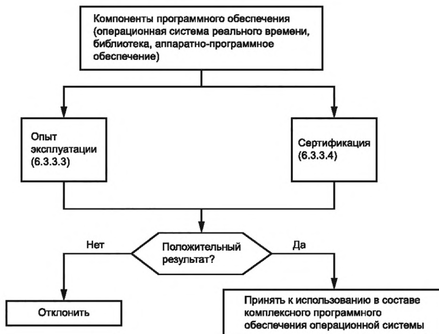
Рисунок 6 — Общая схема типичного процесса квалификации компонентов ранее разработанного ПО
