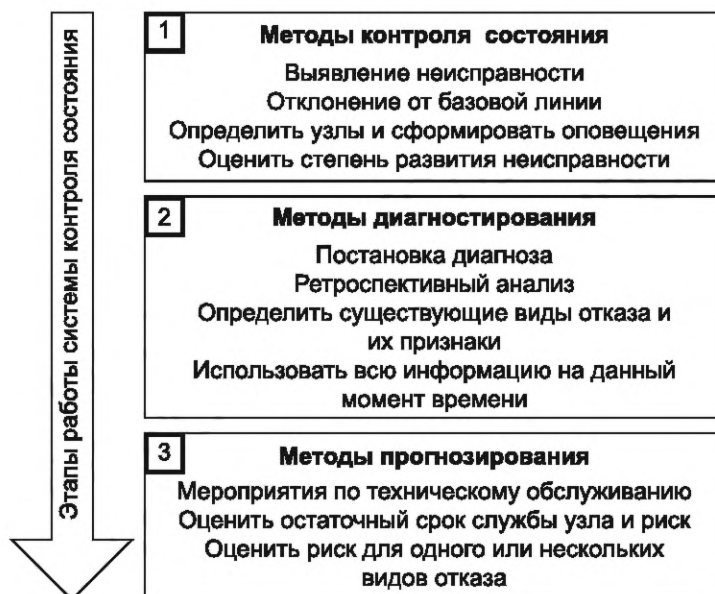
Рисунок 3 — Соотношение методов контроля, диагностирования и прогнозирования
