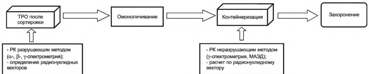
Рисунок Б.4 — Производственно-технологическая цепочка обращения с неперерабатываемыми РАО АС с указанием этапов проведения РК
