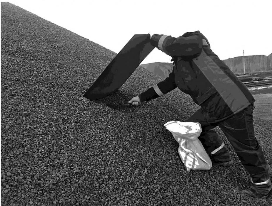
Рисунок 8 — Отбор точечных проб из штабеля с помощью пробоотборного листа
