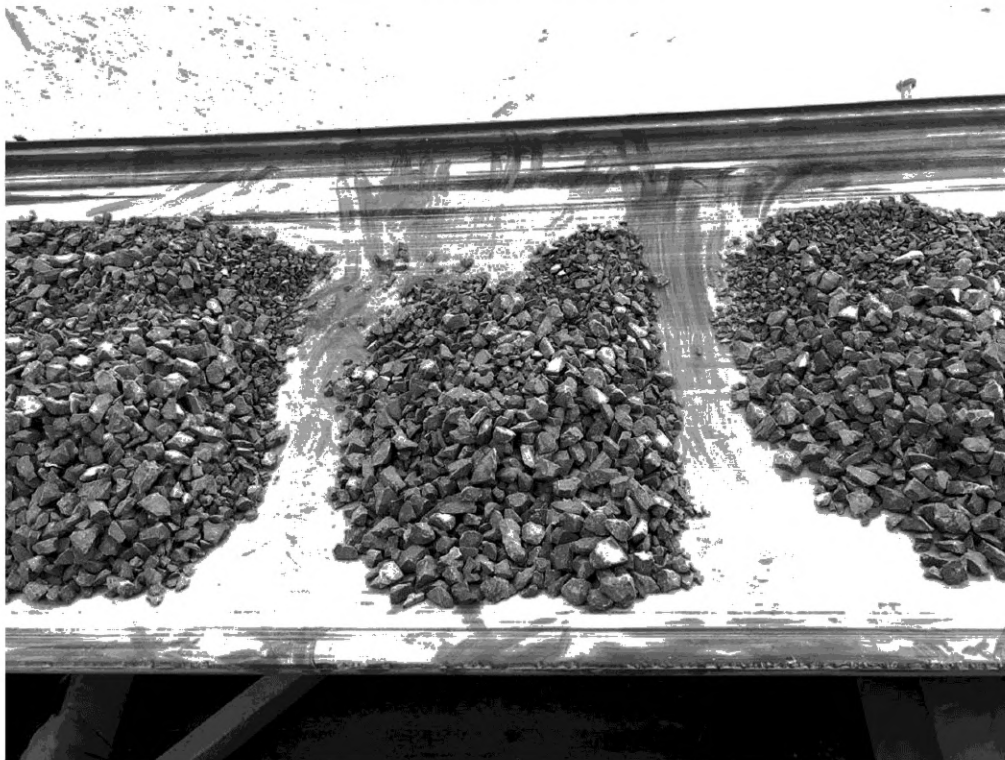
Рисунок 4 — Отбор точечной пробы без применения пробоотборной рамы
