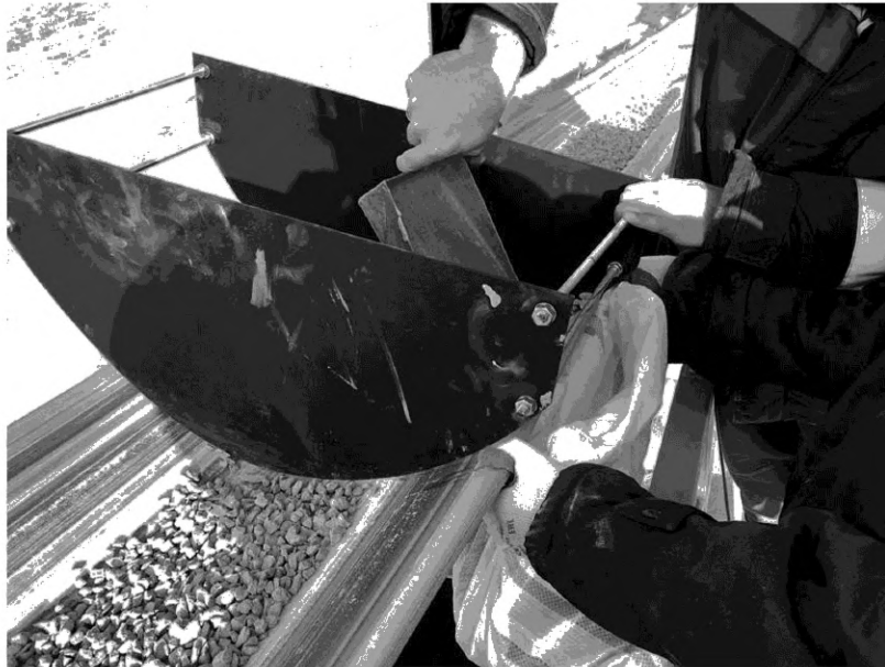
Рисунок 3 — Отбор проб с неподвижной конвейерной ленты при помощи пробоотборной рамы и совка
