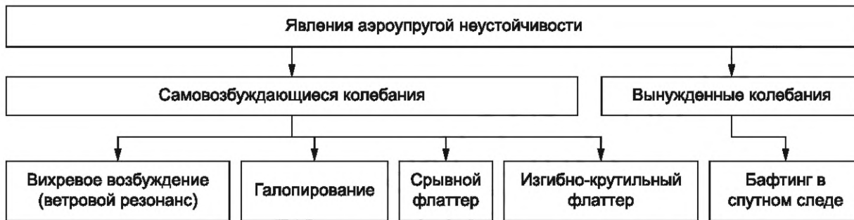
Рисунок 1 — Явления аэроупругой неустойчивости
