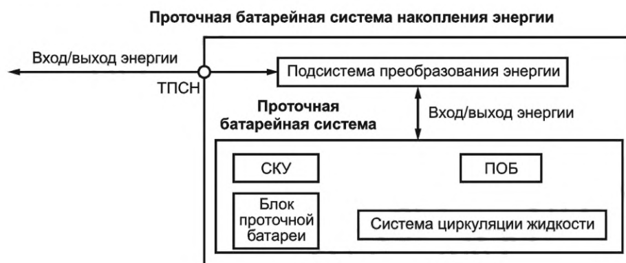
Рисунок 1 — Пример архитектуры СНЭБП
