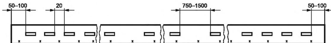
Рисунок 5.1 — Интервал между последующими маркировочными обозначениями
