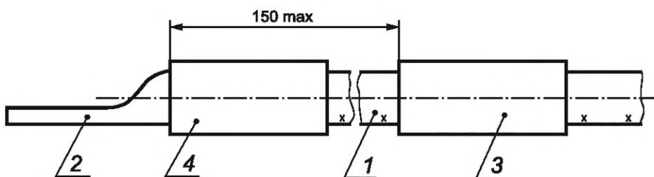
1 — провод; 2 — наконечник; 3 — бирка; 4 — изоляционная трубка
