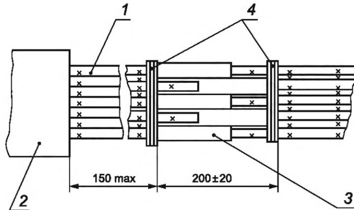
1 — провод; 2 — электрический соединитель; 3 — бирка; 4 — бандаж
