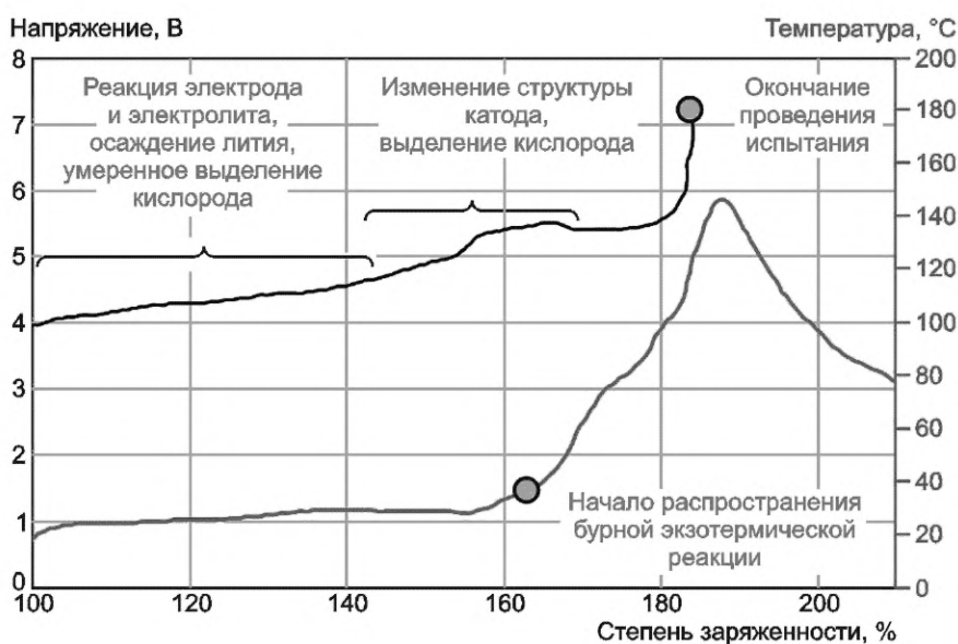
Рисунок А.1 — Тепловой разгон на примере литий-ионного аккумулятора с катодом, содержащим кобальтат лития
