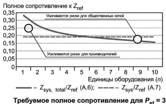
Рисунок А.3 — Требования к полному сопротивлению как функции отдельных значений P_{st@Zref} и степени внедрения n
