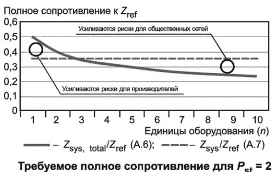
Рисунок А.3 — Требования к полному сопротивлению как функции отдельных значений P_{st@Zref} и степени внедрения n
