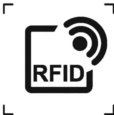
Рисунок 2 — Графическое изображение эмблемы для обобщенного оборудования радиочастотной идентификации (радиочастотная метка, общего назначения по ISO 7000-3010 1) )
