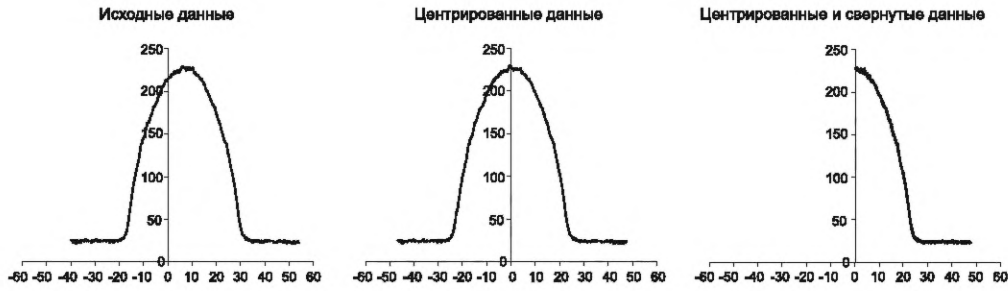
Рисунок Е.2 — Иллюстрация предварительной подготовки одномерных данных в ближнем поле, типовая линия на видеоизображении
