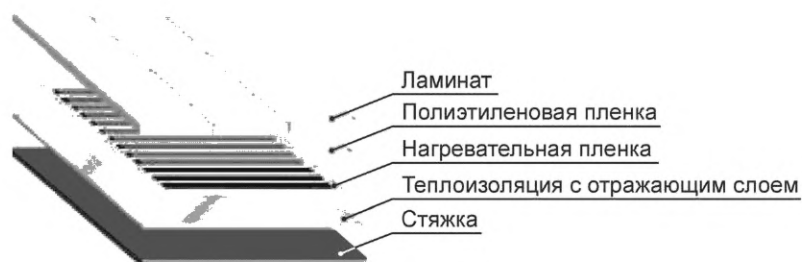
Рисунок Е.3 — Слои пола при установке нагревательной секции на основе нагревательной пленки
