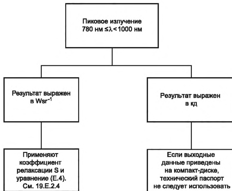
Рисунок F.4 — Блок-схема решения проблемы ИК-излучения менее 1000 нм
