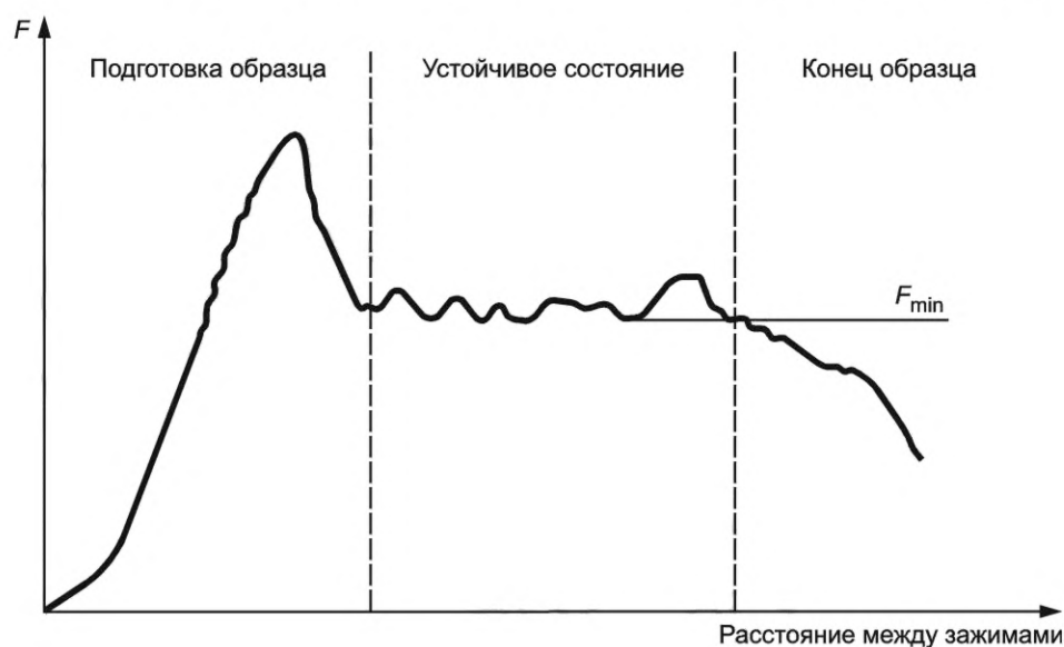
Рисунок G.4 — Типовой график зависимости прочности от расстояния между зажимами (вариант 1)
