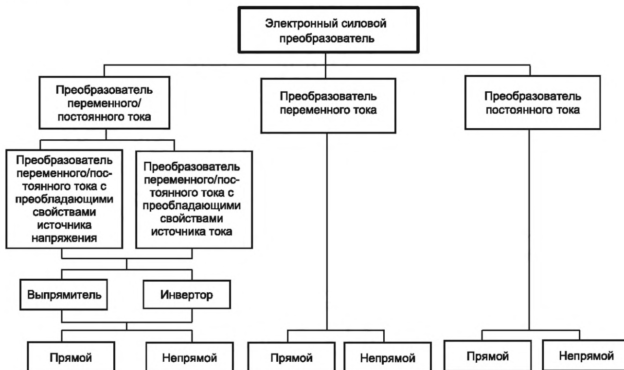
Рисунок 1 — Примеры базовых электронных преобразователей мощности
