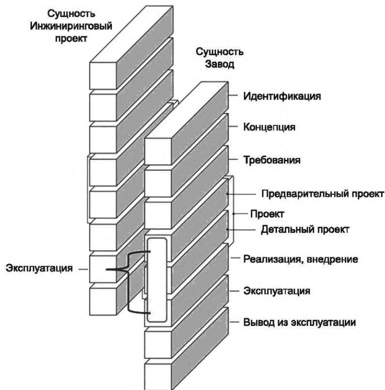
Рисунок В.4 — Взаимодействие жизненных циклов сущностей Инжиниринговый проект и Завод
