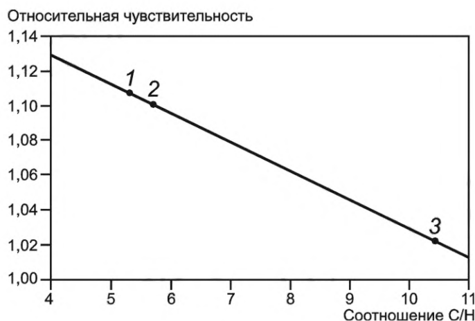
Рисунок 1 — Зависимость относительной чувствительности определения серы от соотношения C/H
